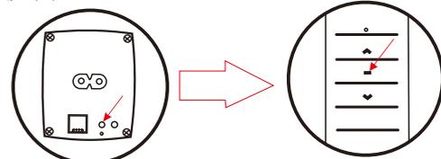
电机通电后，长按电机底部“学码”键，直至指示灯长亮，松手
